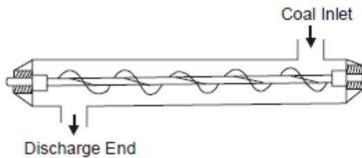
Fig. 4.4. Screw Conveyor.
